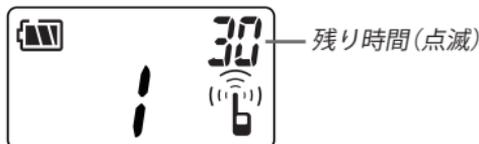
本機の1回の通信時間は、送信・受信を合わせて3分間です。通信終了の30秒前になると、表示部の数字が点滅しながらカウントダウンを始めます。10秒前になると「ピッ」と予告音が鳴り、3分を経過すると送信禁止音(プー)とともに送信を停止し、待ち受け状態に戻ります。続けて通信するときは、送信停止2秒後に【PTT】を押して相手呼び出してください。
