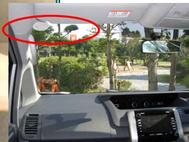
CDMAアンテナ 取付場所
