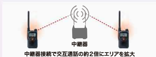
中継器接続で交互通話の約2倍にエリアを拡大
