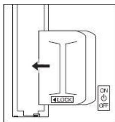
ロックカバーを矢印の方向へスライドさせて取り外します。
