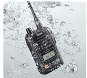
\*バッテリーバック、アンテナを正しく装着した状態で、試験用粉塵を1m<sup>3</sup>あたり2kgの割合で浮遊させた中に8時間放置したのちに取り出して、無線機の内部に粉塵の混入がないこと。また、水深1mの静水（常温の水道水）に静かに沈め、30分間放置したのちに取り出して、無線機として機能することです。
