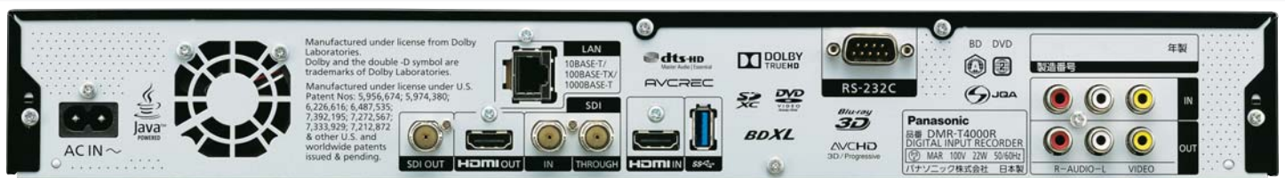
リアパネルにHD-SDI入出力、HDMI入出力、アナログ入出力、RS-232C端子を装備。
