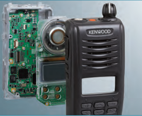
落下・衝撃に強い二重構造パネル
