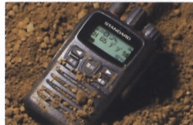
衝撃に強い構造 高性能ポリカーボネートと ダイキャストシャーシで 集積基板をガード
