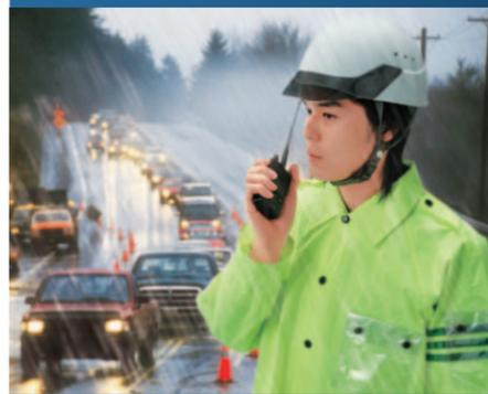
本体の最下部が水面下1mで30分間水中に没しても内部に水がはまらない、JIS保護等級7(防浸形)の防水性能。雨の中や水を扱う業務でも、安心して使用いただけます。
