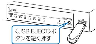
**11** [POWER]ランプが●緑点灯に切り替わったことを確認してから、[USB]ランプが消灯するまで、〈USB EJECT〉ボタンを押しつづけます。
