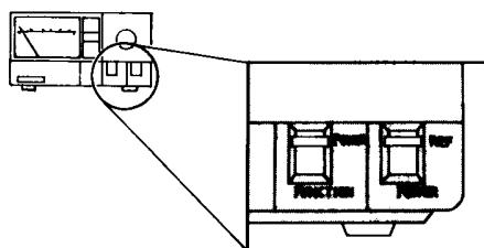
3. 「RANGE」スイッチを測定しようとする電力に合わせます。送信出力が10Wの場合は30Wレンジにします。
