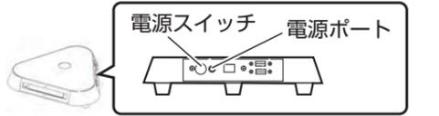
1. 付属の AC アダプターをデスクスタンドの【電源ポート】に根元まで確実に接続する。
