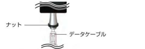
5. 【端末取付穴】に【データケーブル】を通し、ナットを締める
