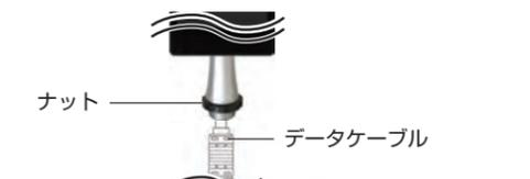
3. 【端末取付穴】に【データケーブル】を通し、ナットを締める
