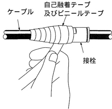
防水処理は確実にこなってください。防水処理が不十分ですと内部に雨水が浸入し、性能低下、故障の原因となります。
