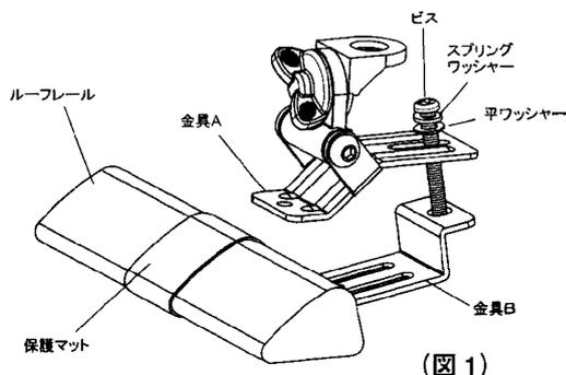
④金具A,Bをルーフレールの大きさに合わせて図のように横方向にスライドさせルーフレールをしっかりと挟み込みます。金具A,Bが平行になるように、プラスドライバーにてビスを固定してください。(図3)
