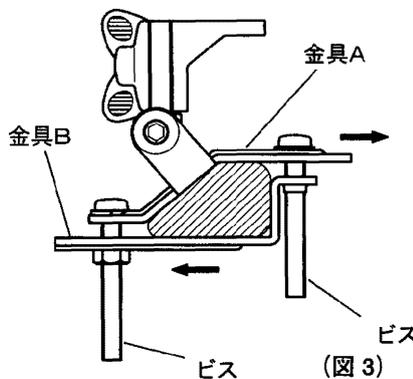
③反対側のビスを図のように組み立て、金具A,Bがルーフレールに触れる程度に締め付けます。(図2)
