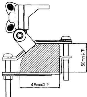
2種類のビスが付属しています。ルーフレールのサイズに合わせてお使いください。フロントノブにより、車庫入れ時にアンテナを倒すことができます。
