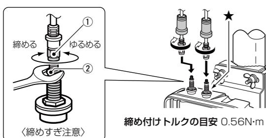
本製品側コネクター(②)を工具等で固定しながら、アンテナ側コネクターの接栓(①)を手で回して、接続や取りはずししてください。
