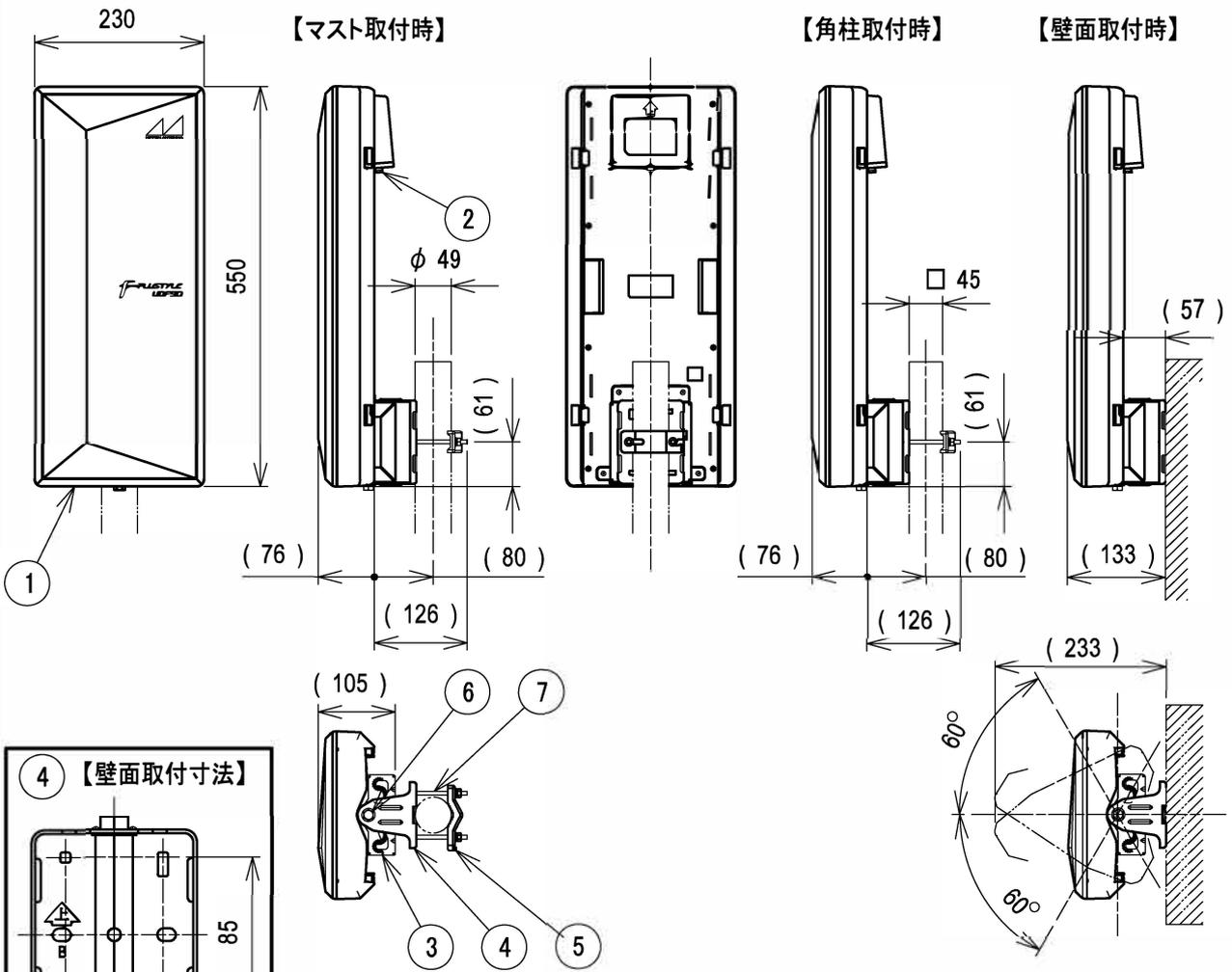
・マスト取付の場合および角柱取付の場合の質量は2.7kg、壁面取付の場合の質量は2.6kgです。(共にアンテナ本体質量2.2kg含む)
