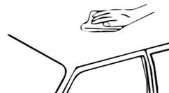
※基台を取り付け直す場合は、必ず当社純正部品をお使いください。純正部品をご使用いただくときも、ベース金具に残った両面テープは完全に取除いておいてください。残った状態での貼り付けは強度が弱くなり危険です。
