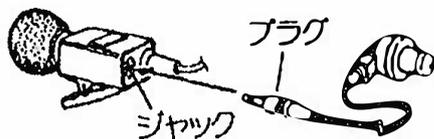
2. トランシーバーの電源を切り、本体接続用プラグをトランシーバーの MIC/SP ジャックに取り付けてください。
