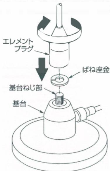
基台ねじ部にばね座金を取付けてエレメントプラグをねじ込んでください。
