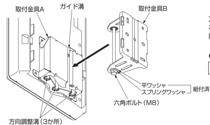
六角ボルト(M8)を、ガイド溝から挿入していずれかの方向調整溝に押し込み、しっかりと基準の締付トルクで締付けてください。
