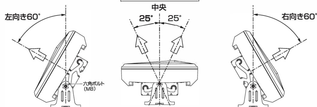
●アンテナ方向を決めたら、六角ボルト(M8)を基準の締付トルクでしっかり締付けてください。
