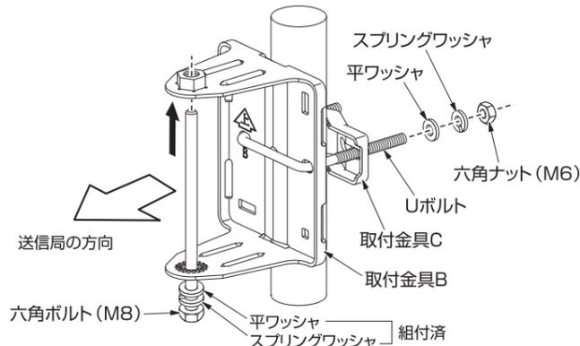
Uボルトと取付金具Cとを使用して、しっかりと基準の締付トルクで設置場所に組付けてください。Uボルトを取付金具Bに組込む際は、六角ボルト(M8)を一旦取りはずします。
