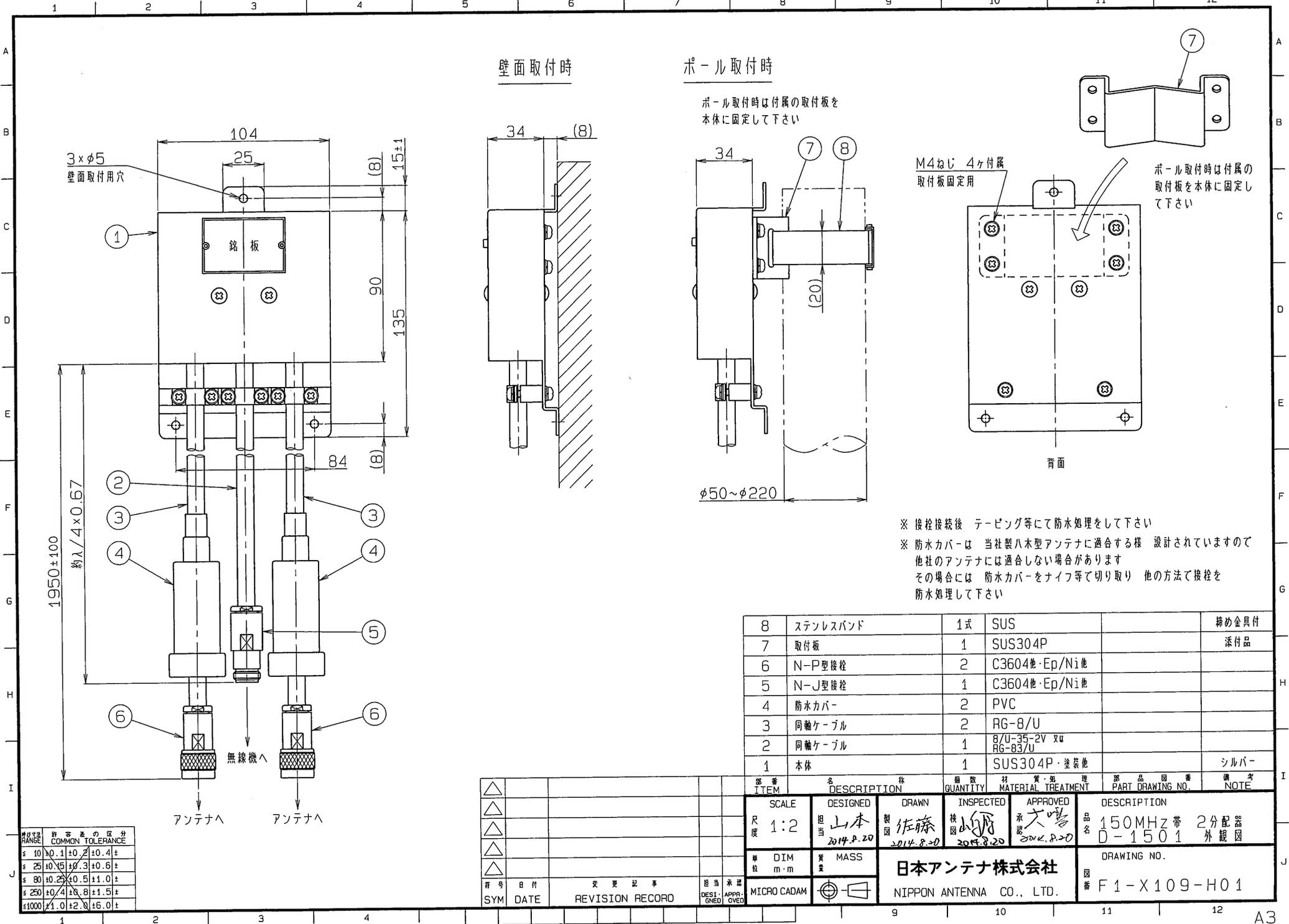
※ 接栓接続後 テーピング等にて防水処理して下さい
