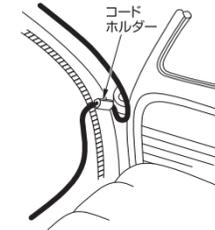
エンジンルーム、温風吹出口のような高温の箇所は同軸ケーブルの内部が溶け、アンテナ性能が損なわれます。
