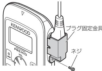
ネジをプラスドライバー(#1)で右方向に回し確実に締め付けてください。
