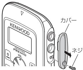
プラスドライバー(#1)でネジを左方向に回して取り外し、カバーを外します。
