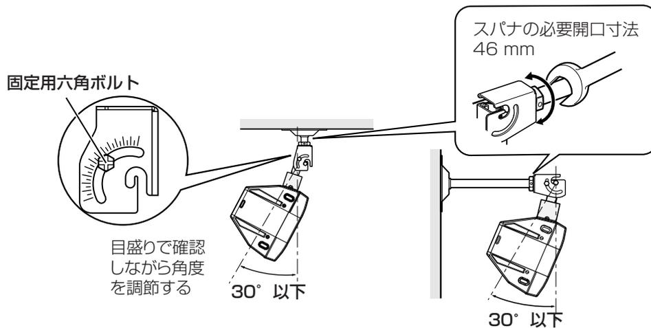
②ナットAでスピーカーの水平角度を調節します。
