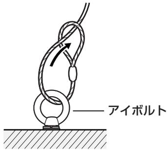
※アイボルトへ通したあと、必ず落下防止ワイヤーを金具Aと金具Bの間に通してください。
