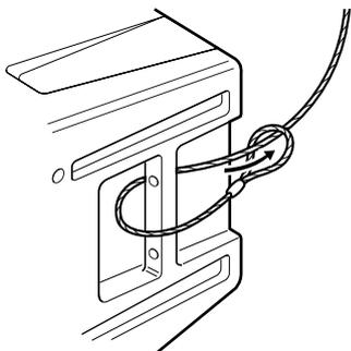
※取っ手へ通したあと、必ず落下防止ワイヤーを金具Aと金具Bの間に通してください。
