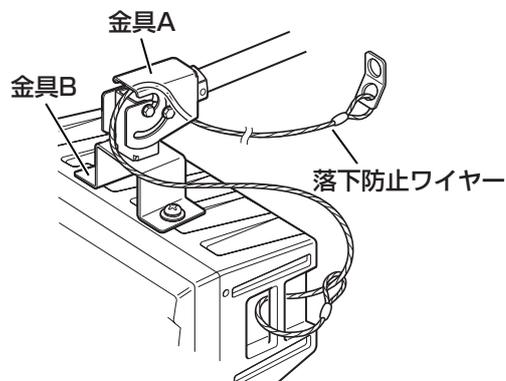
スピーカー取付金具WS-Q138-B/W（天井取付）の場合
