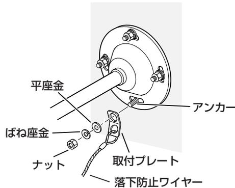
※平座金、ばね座金、ナットは取付場所の材質にあわせて別途調達してください。
