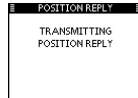
DSC設定の「POSITION ACK」(☞P65)を「Auto」に設定しておくと、ポジションリクエストを受信したときに自動で応答します。
