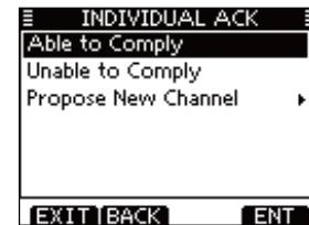
DSC設定の「INDIVIDUAL ACK」(☞P65)を「Auto (Unable)」に設定しておくと、個別呼び出しを受信したときに自動で応答します。
