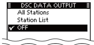
**All Stations:** 受信したすべてのDSC呼び出しを、NMEA出力端子から出力します。
