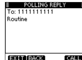
DSC設定の「POSITION ACK」(☞P65)を「Auto」に設定しておくと、ポーリングリクエストを受信したときに自動で応答します。
