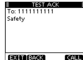
DSC設定の「TEST ACK」（☞P65）を「Auto」に設定しておくと、ポジションリクエストを受信したときに自動で応答します。
