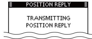
GPS受信機を接続せず、位置情報と時刻情報を手動で設定したときは、以下の画面を表示します。
