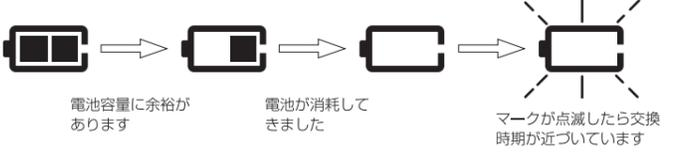
「電源が入らない」「ON / OFF を繰り返す」「ディスプレイ表示が消える」「ハウリング」などの症状が出た場合も電池の消耗が考えられます。新しい電池と交換してください。
