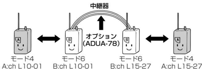
複信連結中継通信モードでは「強制タイプ」と「電話タイプ」の2つのタイプが選択できます。[ファンクション] キーを押し、点灯中に[Fック] キーを約2秒押しすと切り替わります。「電話タイプ」を選択すると、が点灯します。
