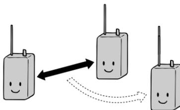
同時通話モードでは「強制タイプ」と「電話タイプ」の2つのタイプが選択できます。[ファンクション] キーを押し、
