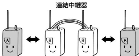
直接の通信ではつながらない相手と、連結中継器を介して同時通話モードのように通信するモードです。連結中継器として、弊社製DJ-R20D、DJ-R100Dなどがペアで必要です。
