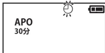
**注意** オートパワーオフで電源が切っていても、若干の電流を消費しています。バッテリーの過放電防止のためにも、ご使用後は必ず電源ツマミで電源を切ってください。
