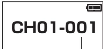
「通報ボタン」を押して「相手局の個別ID」を点滅させてから「▲」・「▼」キーで相手局を選択します。このとき「MODE」キーを押すと表示点滅の桁が移動します。もう一度「通報ボタン」を押して点滅を止めたら選択が決定します。
