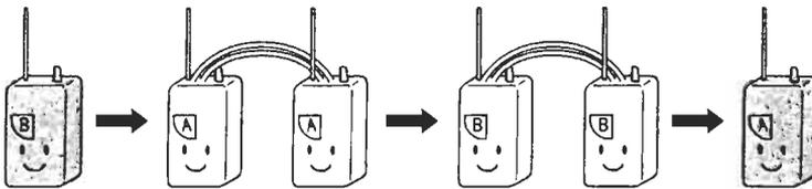
通常の交信ではつながらない相手と中継器を多段連結して、モード1（単信無線モード）のように交信するモードです。
