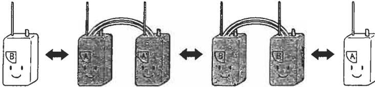
モード4、8の中継器として使用するモードです。中継器は多段連結が可能で、遠距離の通話に利用できます。
