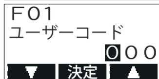
⑥ [機能] (決定) キーを押すと、ユーザーコードの点滅している桁が右に移動します。
