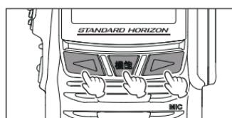
④ 「FO1 ユーザーコード」が表示されますので、[機能] (選択) キーを押します。
