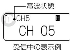
通話相手以外の電波(同じ通話チャンネルで誰かが通話中)を受信しているときも、[送・受] ランプが緑色に点灯し、電波の受信状態を表示します。
