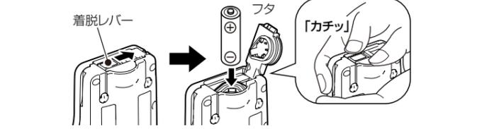
※「カチッ」と音が鳴るまで、両手で確実にフタをしてください。※間違えてプラス(+)側から電池を挿入すると、無線機は動作しません。また、故障の原因になりますので、ご注意ください。※BP-260をはじめてお使いになる場合、必ず充電してください。(裏面参照)また、BP-260に付属の取扱説明書もあわせてお読みください。※運用時間(寿命)は、パワーセーブ機能動作時に送信1分/受信1分/待ち受け8分の時間比で使用した場合、アルカリ乾電池で約33時間\*、BP-260で約30時間\*です。★運用時間は目安です。使用条件や電池の種類(製造元など)により、使用時間が大きく異なることがあります。
