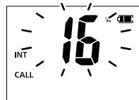
③コールチャンネルを選択している状態で、【16/C】を長く(ピー、ピピッと鳴るまで)押すと、コールチャンネルの設定モードに入ります。
