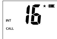
②【16/C】を長く(約1秒)押すと、国際チャンネルのコールチャンネルを表示します。
