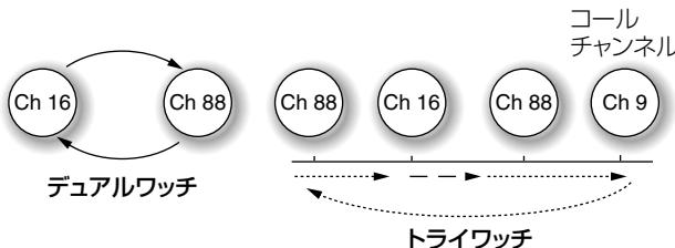
※チャンネル16で信号を受信した場合、その信号がなくなるまでチャンネル16でデュアルワッチ/トライワッチは、一時停止します。
