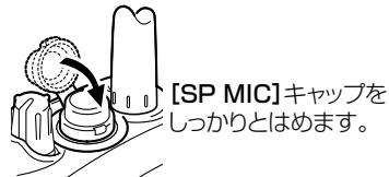
※スピーカーマイクロホン(ヘッドセット)を取り付けないときは、ホコリや水の侵入を防ぐため、[SP MIC]キャップを装着してください。
