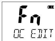
② 「OC EDIT」を表示したらすぐに、[H/L•LOCK]を短く押します。
