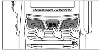
⑥ [機能] (決定) キーを押すと、ユーザーコードの点滅している桁が右に移動します。
