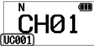
④ 「FO1 ユーザーコード」が表示されますので、[機能] (選択) キーを押します。
