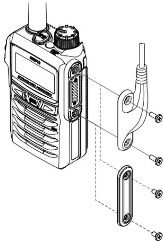
**注意** オプション類を取り付け取り外しする時は、必ずトランシーバーの電源をオフにしてください。
