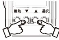
チャンネルセレクトーツマミを右(時計方向)に回す、またはUP(▲)ボタンを押すとチャンネルがアップします。
